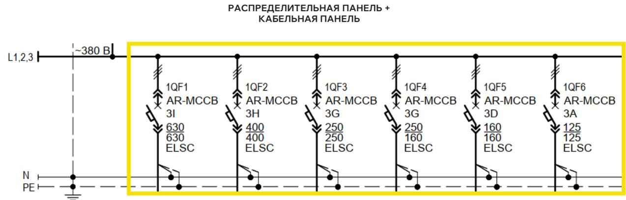
В альбоме решений дан пример проектирования распределительной панели со встроенным шинным отсеком.
