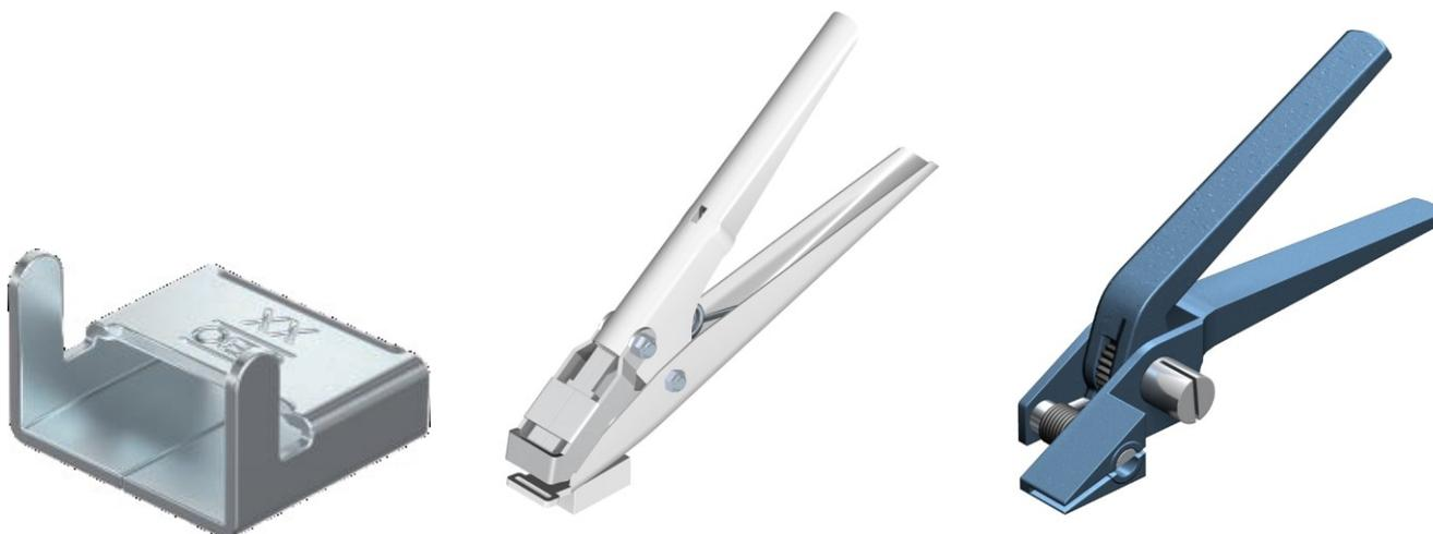
Фиксатор продается в упаковках по 100 штук, что весьма удобно для использования с лентой в рулоне. Мы предлагаем два варианта обжимных клещей для фиксатора – они отличаются наличием храпового механизма для натяжки ленты перед фиксацией у модели 576, что делает монтаж еще более удобным и быстрым.
